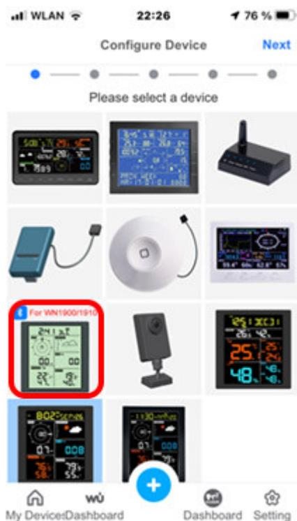
3) Bitte das angebotene Firmwareupdate ausführen und dann den Scan Button drücken, damit das Heimnetzwerk Wlan angezeigt wird. Nach Auswahl des gewünschten Netzwerknamens aus der Liste funktioniert auch die Verbindung (Wichtig: 2,4Ghz und b Standard).
