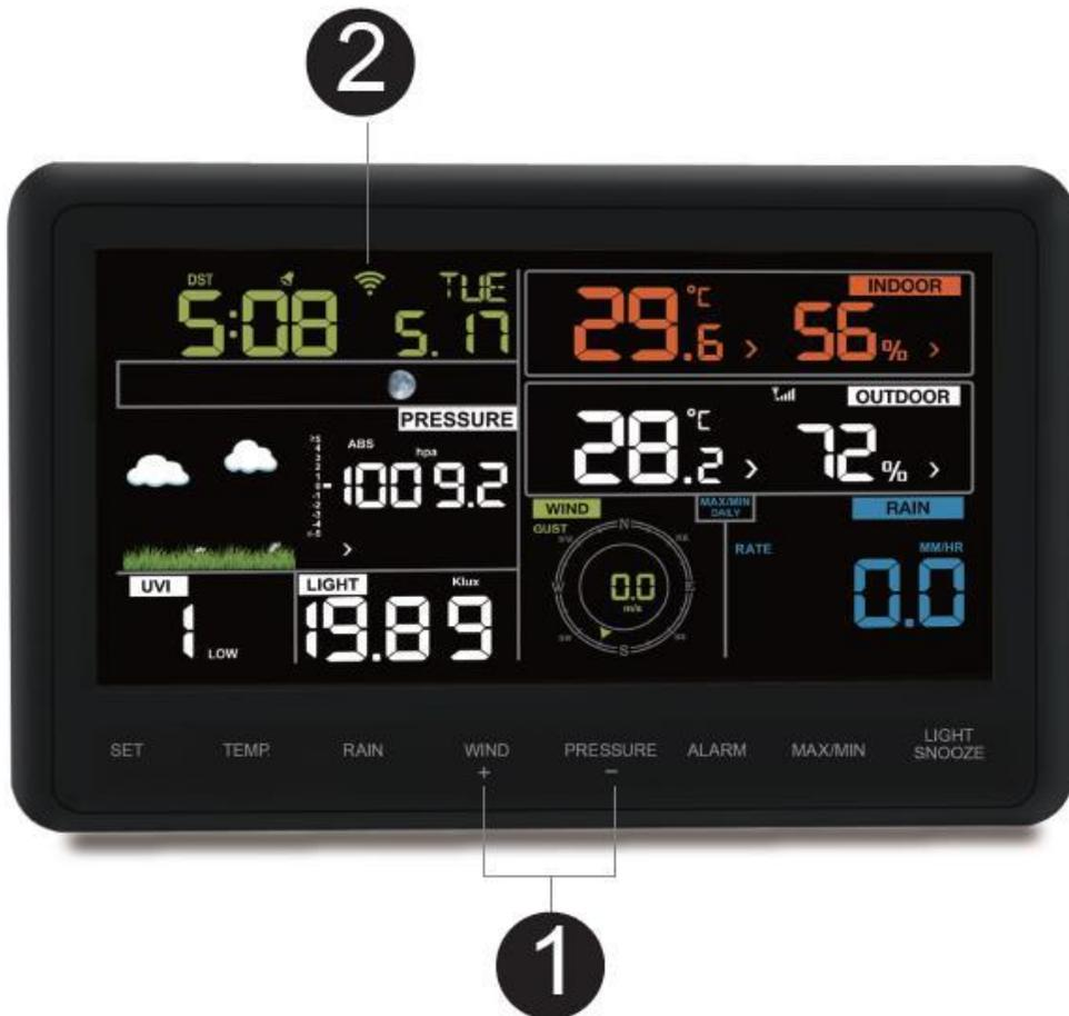
4. Mientras el ícono de Wi-Fi parpadea, verifique el Wi-Fi en su teléfono móvil y busque EasyWeather WiFi. Asegúrese de que su teléfono esté conectado a EasyWeather WiFi y seleccione NO cuando aparezca el mensaje "No hay acceso a Internet" (si la conexión falla, cierre los programas de fondo en el teléfono y vuelva a intentar) ,
