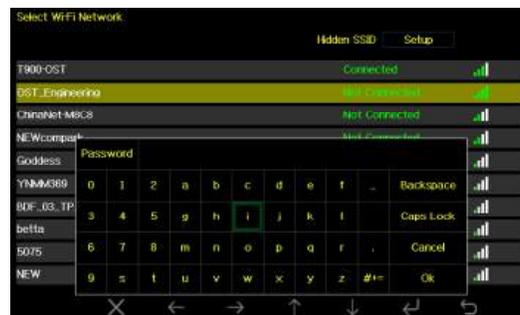
Pulse el botón **↑** o **↓** para seleccionar la red Wi-Fi. Pulse el botón **↵** para confirmar e introducir la contraseña. Pulse la tecla **↶** para volver al modo de visualización normal. Es posible que su red no aparezca en la lista cuando se realiza
