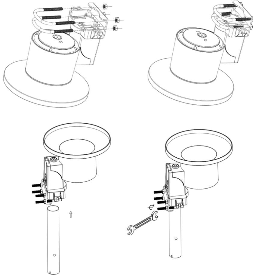
**Hinweis:** Verwenden Sie die Wasserwaage neben dem Regensensor als Leitfaden, um zu überprüfen, ob der Sensor nivelliert ist.
