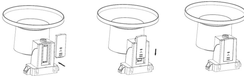
**Hinweis:** Wenn keine LED aufleuchtet oder dauerhaft leuchtet, stellen Sie sicher, dass die Batterie auf die richtige Art und Weise eingelegt wird oder ein ordnungsgemäßer Reset durchgeführt wird. Setzen Sie die Batterien nicht verkehrt herum ein. Sie können den Außensensor dauerhaft beschädigen.
