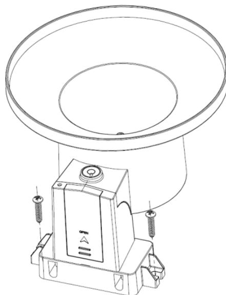
**Hinweis:** Verwenden Sie die Wasserwaage neben dem Regensensor als Leitfaden, um zu überprüfen, ob der Sensor nivelliert ist.
