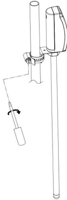
Abbildung 5: Befestigung des Sensors am Mast
